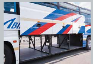
貫通式の大型トランクルーム
