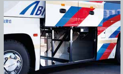
貫通式の大容量トランクルーム
